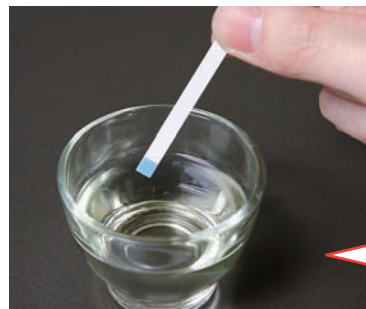
AVチェック検査紙で酸価値を計測する
